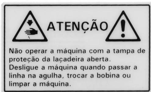
Adesivo de advertência quanto ao risco de perfuração/corte nas mãos e dedos em contato com a lançadeira e demais elementos.
